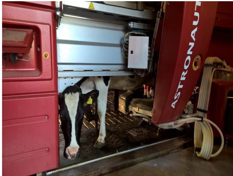
Figuur 2-10: De melkrobot, toepassing van Internet of Things en Big Data in de melkveesector.
