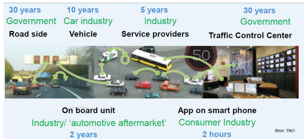
Figuur 2-2: Innovaties in ITS zijn complex door de diversiteit in systemen met hun verschillende doorlooptijden, uiteenlopende belanghebbenden (markt en overheid) en het risico van kip-en-ei dilemma's.
